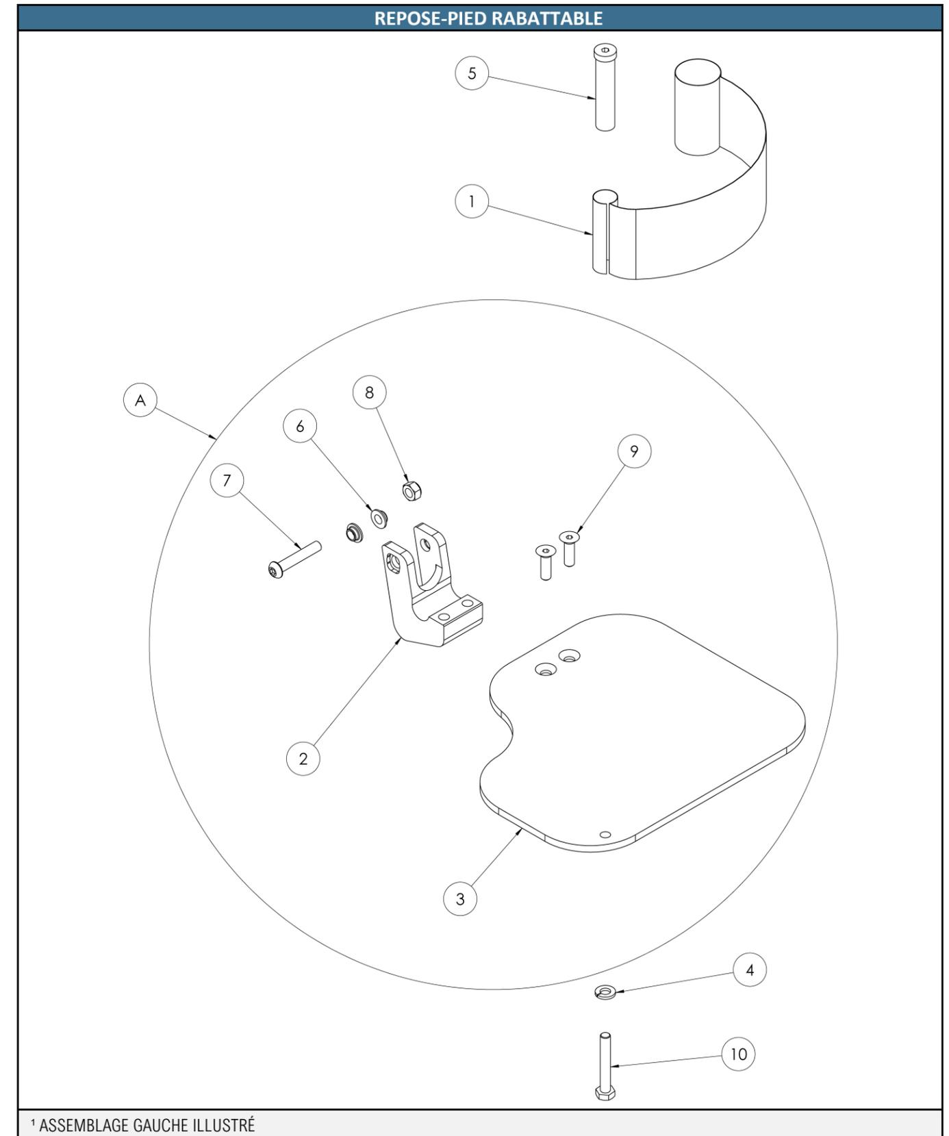
**REPOSE-PIED RABATTABLE ET AJUSTABLE EN ANGLE ET PROFONDEUR**
