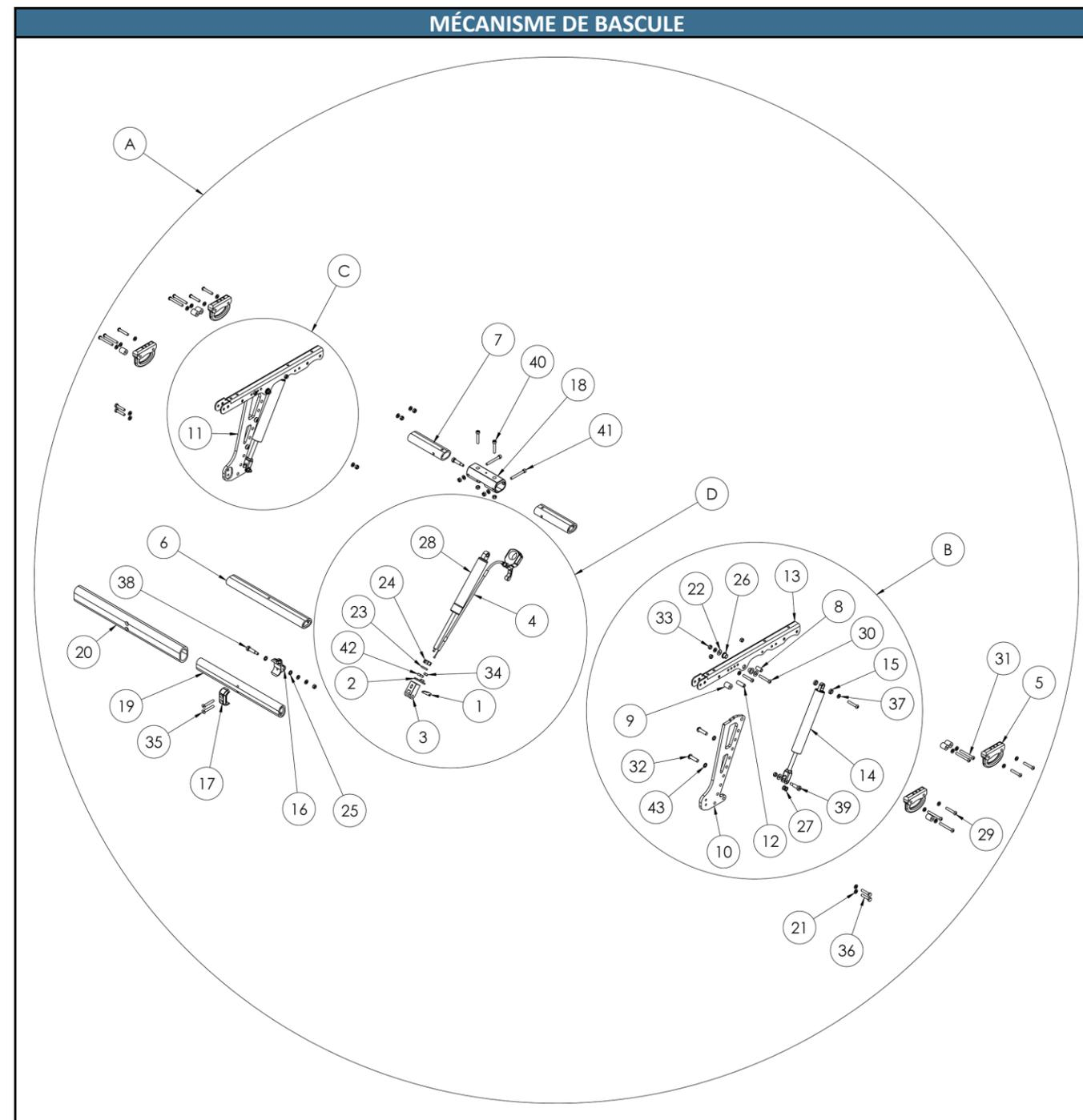
**MÉCANISME DE BASCULE ÉLECTRIQUE**
